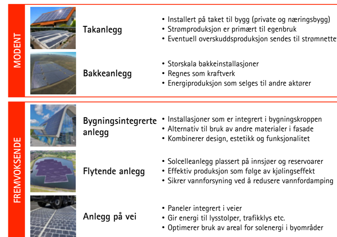
Figur 2: Anlegg for produksjon av solkraft
